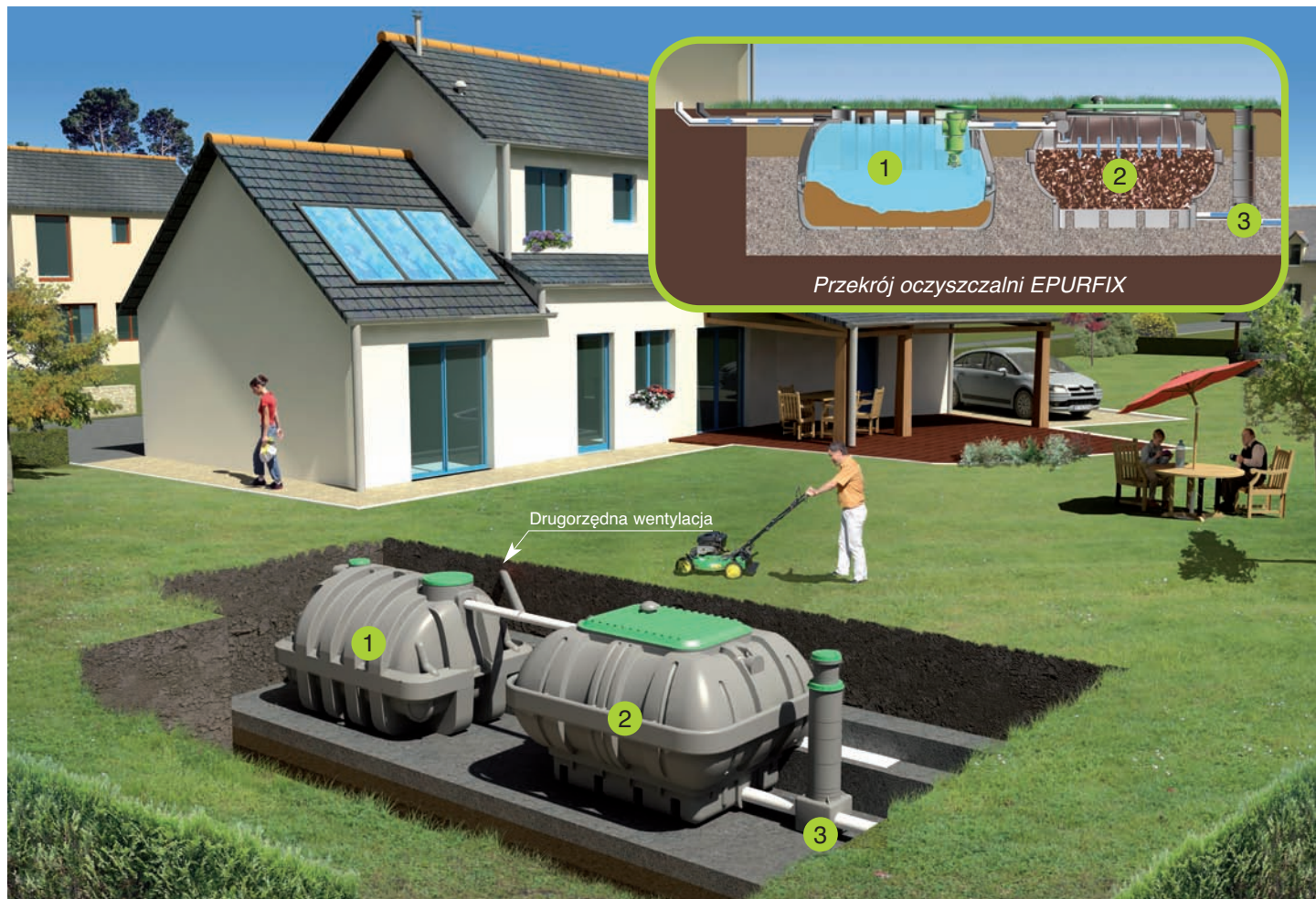
Przykład instalacji oczyszczalni EPURFIX CP 5EH zawierającej osadnik i filtr kokosowy EPURFIX.
